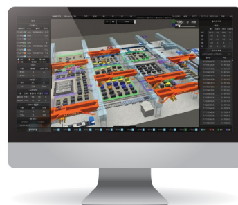
➤ 무인 크레인(슬라브 & 코일야드) HMI
